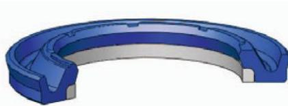
K29 – амортизирующее уплотнение одностороннего действия, состоящее из двух частей: одного эластичного элемента уплотнения сконструированного специально для компенсации обратного давления и одного опорного кольца из термопластичного материала.
