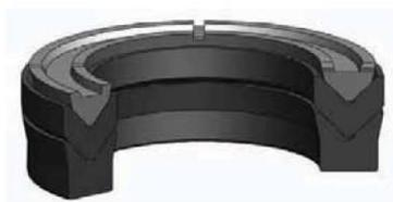
K03 - комплект уплотнений одностороннего действия, состоящий из трех частей: одного опорного кольца из упрочненной хлопковой ткани, одного эластичного промежуточного кольца из нитрильного каучука и одного нажимного кольца из термопластичного материала.
