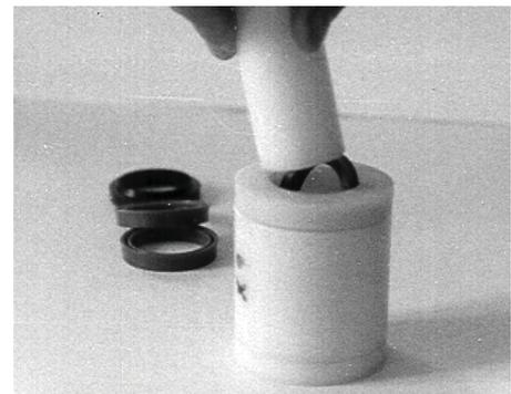
4) Вдавить уплотнение пластиковой втулкой до полной посадки в канавку
