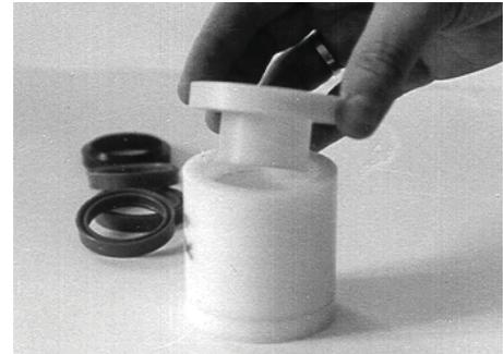
2) Вставить направляющую обойму, которая одновременно закрывает канавку для грязесъемника
