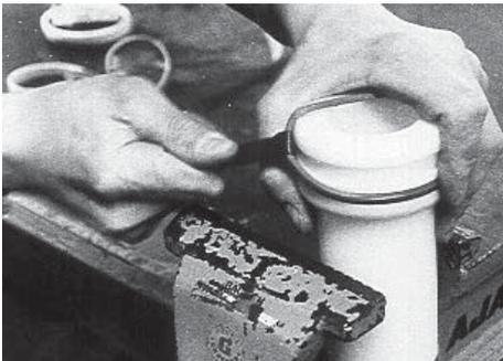
Потом уплотнительное кольцо посадить одной стороной в посадочную канавку и круговым движением при помощи плоской пластиковой ленты перетянуть в эту канавку.
